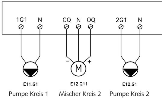
Anschlusskarte PEL – Niederspannung
