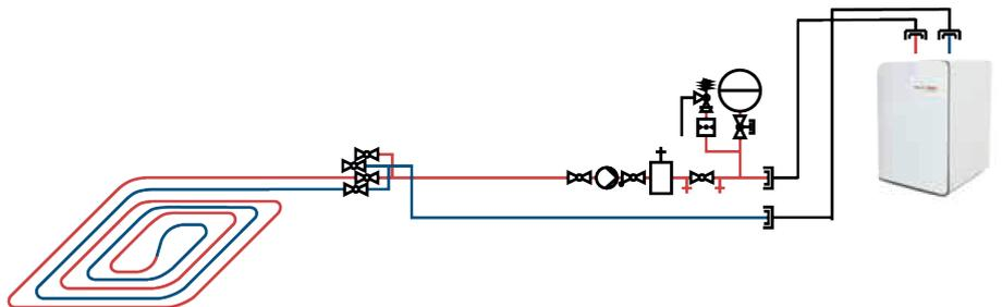
Abb. 14 Hydraulik Schema Primärkreis (Erdkollektor)
