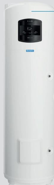
Das Standgerät NUOS III S 200/250 nutzt die Raum- oder Aussenluft und verfügt über ein zweistufiges Elektroheizelement zur Nacherwärmung für die Legionellenschutzschaltung, zur Erreichung von Temperaturen über 62 °C und als Sicherheit bei einer WP-Störung. Dank der Flanschenöffnung vorne und des herausnehmbaren Luftfilters bietet das Gerät zusätzlichen Wartungskomfort. Die Baureihe ist in den Grössen 200 und 250 Liter erhältlich. Weitere Informationen finden Sie auf den Seiten 8-9.
