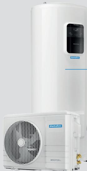
Die NUOS II S 270 S ist ein Stand-Split-Modell, das die Aussenluft nutzt und über ein zweistufiges Elektroheizelement zur Nacherwärmung für die Legionellenschutzschaltung, zur Erreichung von Temperaturen über 62 °C und als Sicherheit bei einer WP-Störung verfügt. Der Inhalt beträgt 270 Liter, weitere Informationen finden Sie auf den Seiten 8-9.
