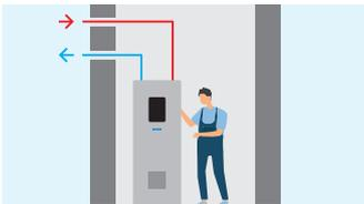
Die Warmwasser-Wärmepumpe zieht die Aussenluft als Zuluft an und führt die Abluft ins Freie zurück. Die Funktionsfähigkeit der Wärmepumpe ist bis zu einer Aussentemperatur von -10 °C garantiert. Vorteil: Keine Auskühlung des Raumes, keine Mindestraumgröße erforderlich.
