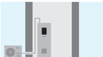
Die Warmwasser-Wärmepumpen NUOS Split 270 verfügt über ein Split-System. Es ist ein Wanddurchbruch für die Verbindungsleitungen notwendig. Die Wärmepumpe ist bis zu einer Aussentemperatur von -10 °C funktionsfähig. Vorteil: Keine Geräuschemissionen im Innenraum, keine Raumauskühlung, keine Mindestraumgröße erforderlich.
