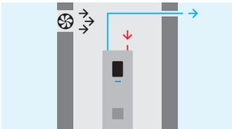
Die Warmwasser-Wärmepumpe nutzt die Raumluft als Zuluft und führt die Abluft ins Freie. Für diese Variante ist Zuluft vom Nebenraum oder Aussen erforderlich, um Unterdruck im Raum zu vermeiden. Vorteil: Geringe Auskühlung des Raumes, keine Mindestraumgröße erforderlich.
