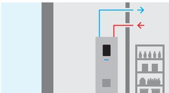
Die Warmwasser-Wärmepumpe nutzt die Raumluft eines benachbarten Raumes als Zuluft und führt die Abluft wiederum dorthin zurück. Die Abkühlung der Raumluft durch das Gerät dient als Kühlung und Entfeuchtung, zum Beispiel eines Vorratsraumes. Der Nebenraum muss über ein Mindestvolumen von 25m<sup>3</sup> verfügen. Vorteil: Gezielte Abkühlung und Entfeuchtung des Nebenraumes, keine Mindestraumgröße erforderlich, keine Auskühlung des Aufstellungsraumes.
