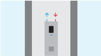
Die Warmwasser-Wärmepumpe nutzt die Umgebungsluft im Aufstellungsraum. Die im Raum vorhandene Abwärme wird optimal genutzt, was zur Effizienzsteigerung des Geräts beiträgt. Der Aufstellungsraum muss über ein Mindestvolumen von 25m<sup>3</sup> verfügen. Vorteil: Mögliche Effizienzsteigerung, ideal zur Wäschetrocknung, Nutzung von vorhandener Abwärme.
