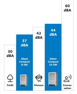
Niveau de pression sonore, comparatif en dB. Les unités extérieures de la série Silent Line se distinguent par une réduction inégalée des émissions sonores. En comparaison avec les autres pompes à chaleur, elles ont un fonctionnement pratiquement inaudible. Mesures effectuées à une distance d'un mètre.
