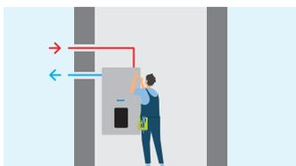
La pompa di calore per acqua calda aspira l'aria esterna quale aria di alimentazione e convoglia l'aria di scarico all'esterno. La funzionalità della pompa di calore è garantita fino a una temperatura esterna di  $-10\text{ }^{\circ}\text{C}$ . Vantaggio: nessun raffreddamento del locale, non è richiesta alcuna dimensione minima del locale.
