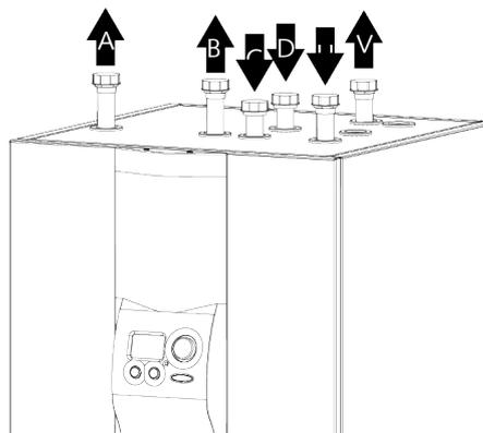
Fig. 14 Raccordi idraulici
