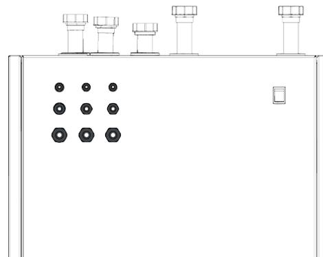
Fig. 11 Pressacavi sul lato posteriore della pompa di calore
