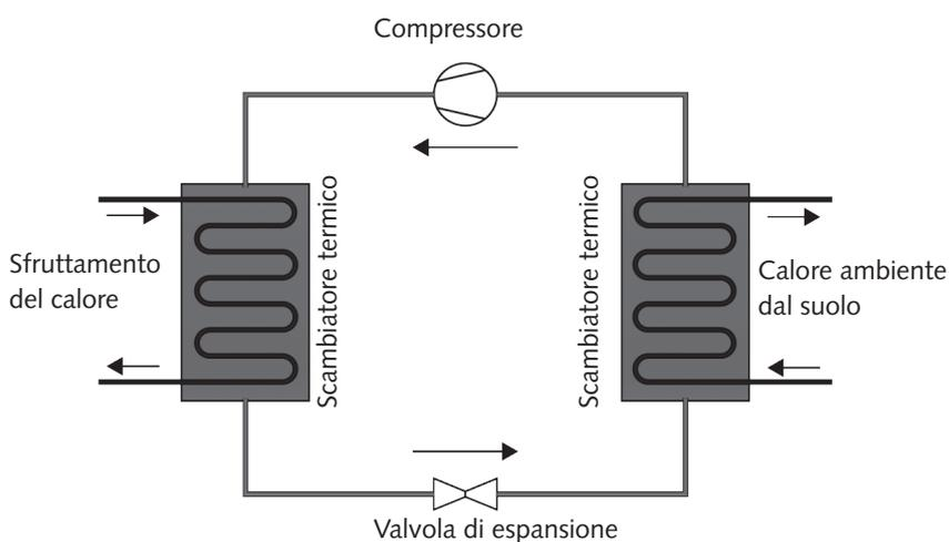
Abb. 1 Principio di funzionamento della pompa di calore
