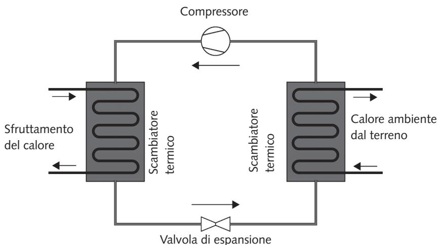
Fig. 2 Principio di funzionamento della pompa di calore
