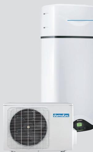
Le modèle NUOS W 110 S est une version murale split, alimentée par l'air extérieur et disposant d'un élément chauffant électrique servant à assurer le dispositif de protection contre les légionelles, à produire une eau d'une température de plus de 62°C et à prendre le relais en cas de dysfonctionnement de la pompe à chaleur. Ce modèle a une cuve de stockage d'une contenance de 110 litres. Vous le trouverez aux pages 10-11.
